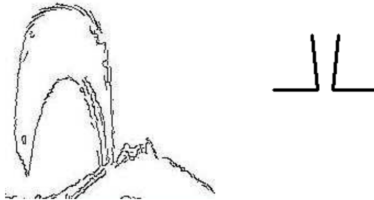
Abbildung 3.5: Eingabebild und Vorlage für die Bildkorrelation zur Ermittlung von \alpha
