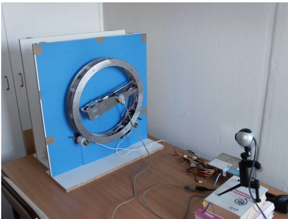
Abbildung 1.1: micro.adam (Version 1) im Blickfeld einer Webcam. Das an seinem Arm befestigte Kabel liefert Servosteuerungsinformationen vom bildauswertenden Computer.
